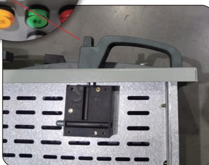
图八 拉手联锁装置
