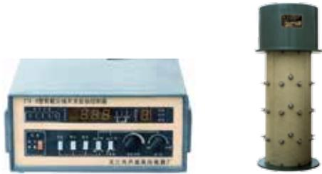
一种以空气作绝缘和灭弧介质的新颖不易燃的有载分接开关，配有ZTK有载分接开关自动控制器，可带有计算机接口，实现远程控制。适用于6~10kV，3150kVA及以下的干式电力变压器。
